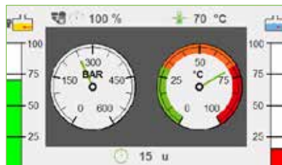
Digitaal display met manometer, temperatuurmeter, urenteller, onderhoudsinfo, storings- en alarmmeldingen en servicefuncties die het onderhoud vergemakkelijken.
