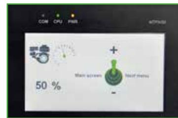
Statusanzeige der Maschine über den Bildschirm, angezeigt werden auch die Betriebsstunden, Wartungsinformationen, Fehlermeldungen und Servicefunktionen, die die Wartung erleichtern.
