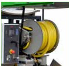
Eingebaute Schlauchtrommel mit 50 m langem 3/4" Niederdruckschlauch
