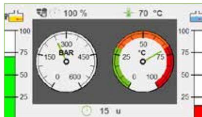
Elektronisch überwachte und angezeigte Füllstands-Menge des Wassertanks und des Kraftstofftanks.
